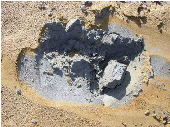
写真 7.25 液状化による噴砂と地中から採取した試料土（見附市）
