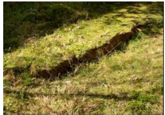
写真 7.26 液状化による地盤の隆起と宅地内の地割れ (長岡市)
