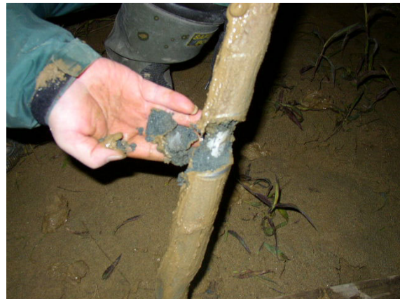
写真 7.25 液状化による噴砂と地中から採取した試料土（見附市）
