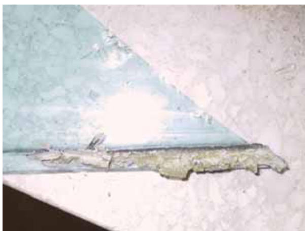
写真3 破損したガラスと硬化性パテ
