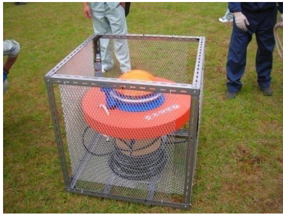
水位計の外観
