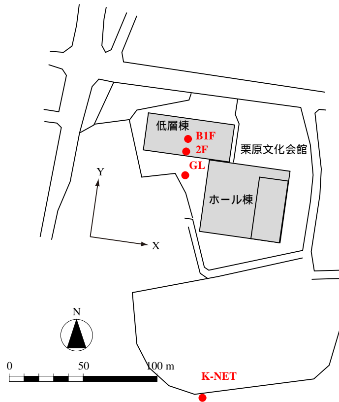
図-3.28 観測地点の配置。B1F 及び 2F は建物内の地下 1 階及び 2 階
