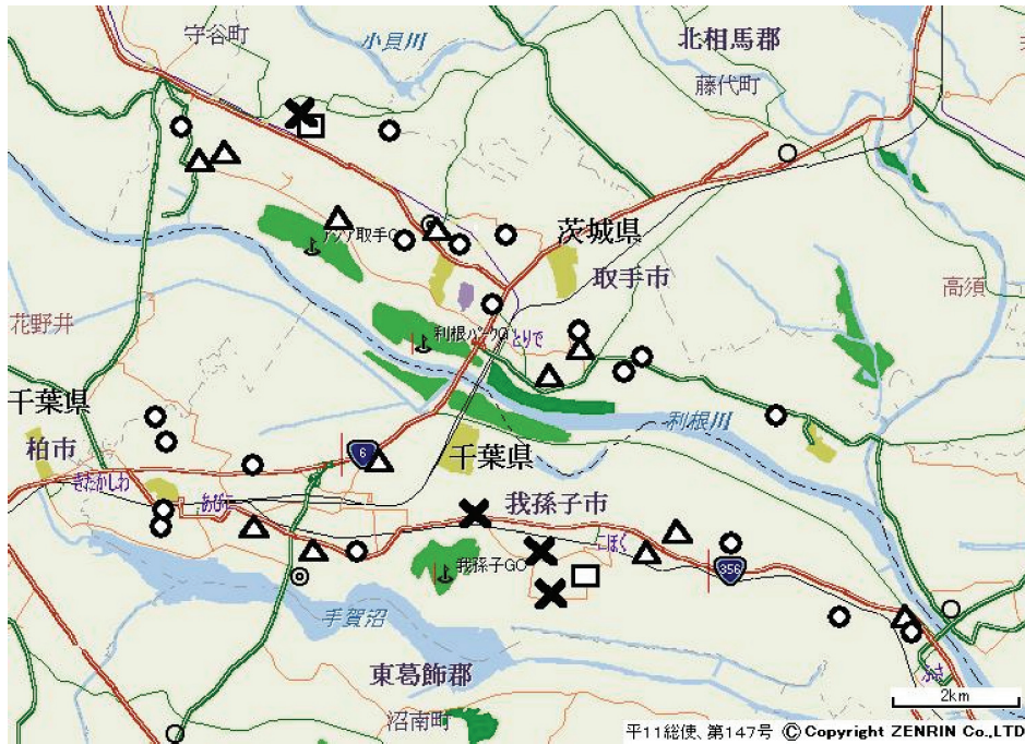
図4 取手市と我孫子市における小中学校のガラスの被害分布 割れた窓ガラスの枚数 ○:0~9, △:10~99, □:100~299, ×:300~
