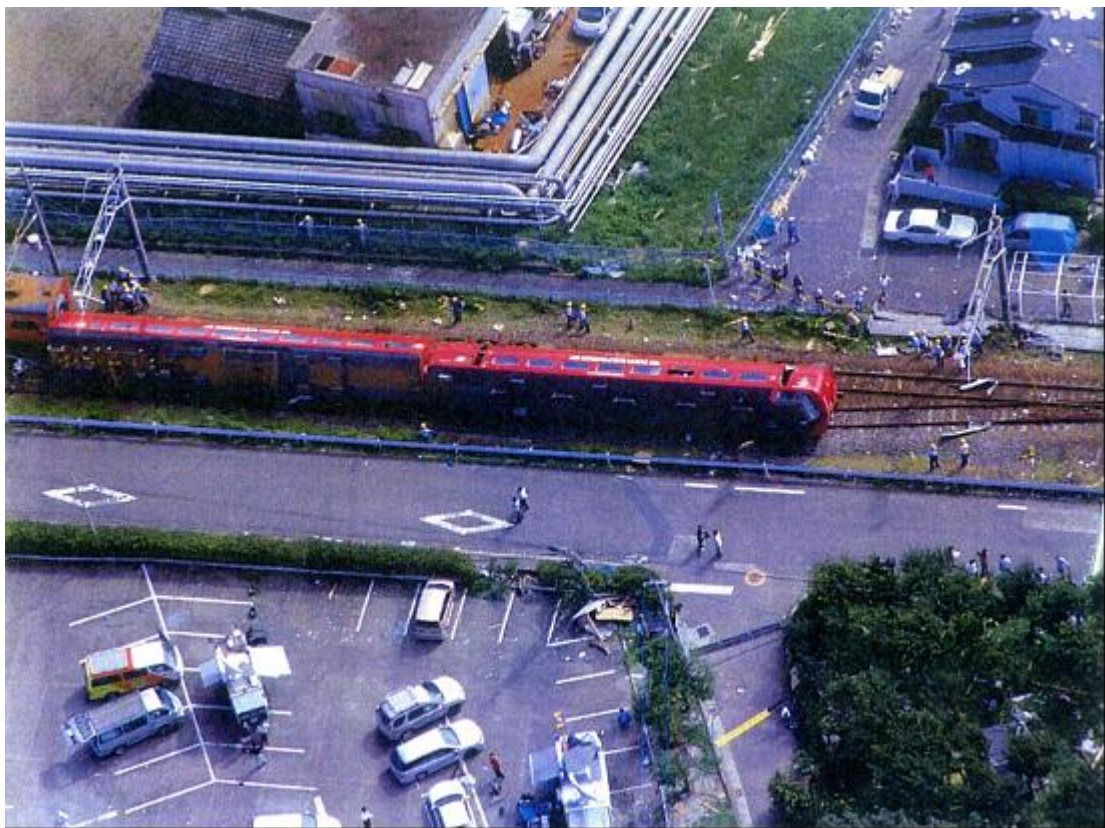
写真3 特急列車の転覆（横転）状況（九州地方整備局提供）
