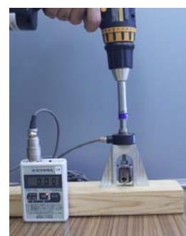
図 1 木ねじプローブ 図 2 携帯型引抜試験器
