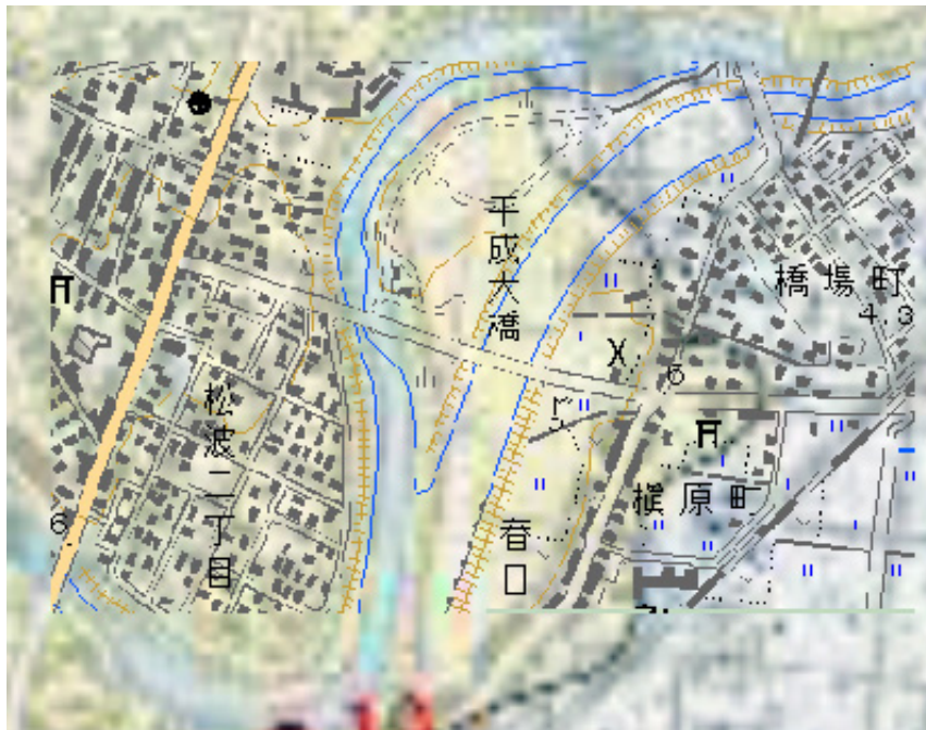
図-8.24 調査地の表層地質（黄色：新期砂丘堆積層、白：沖積平野堆積層） (図-8.2 柏崎市、刈羽村の地形・表層地質状況（出典：新潟県土地分類基本調査図） の表層地質と地形図の調査地域部分を重ねあわせたもの)
