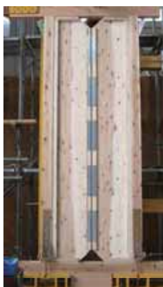
地震エネルギー吸収パネル
