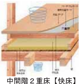
中間階2重床【快床】
