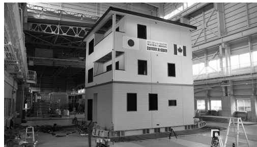
図 3.4.1 試験体外観（大開口無し）
