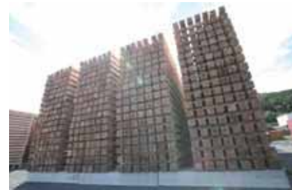
木材は、伐り匂を守り、自社の天然乾燥センターで天然乾燥させることで、木本来の良さを活かす
