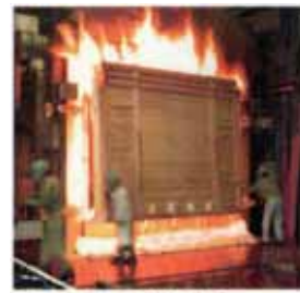
▲ 防火の性能評価試験の様子
