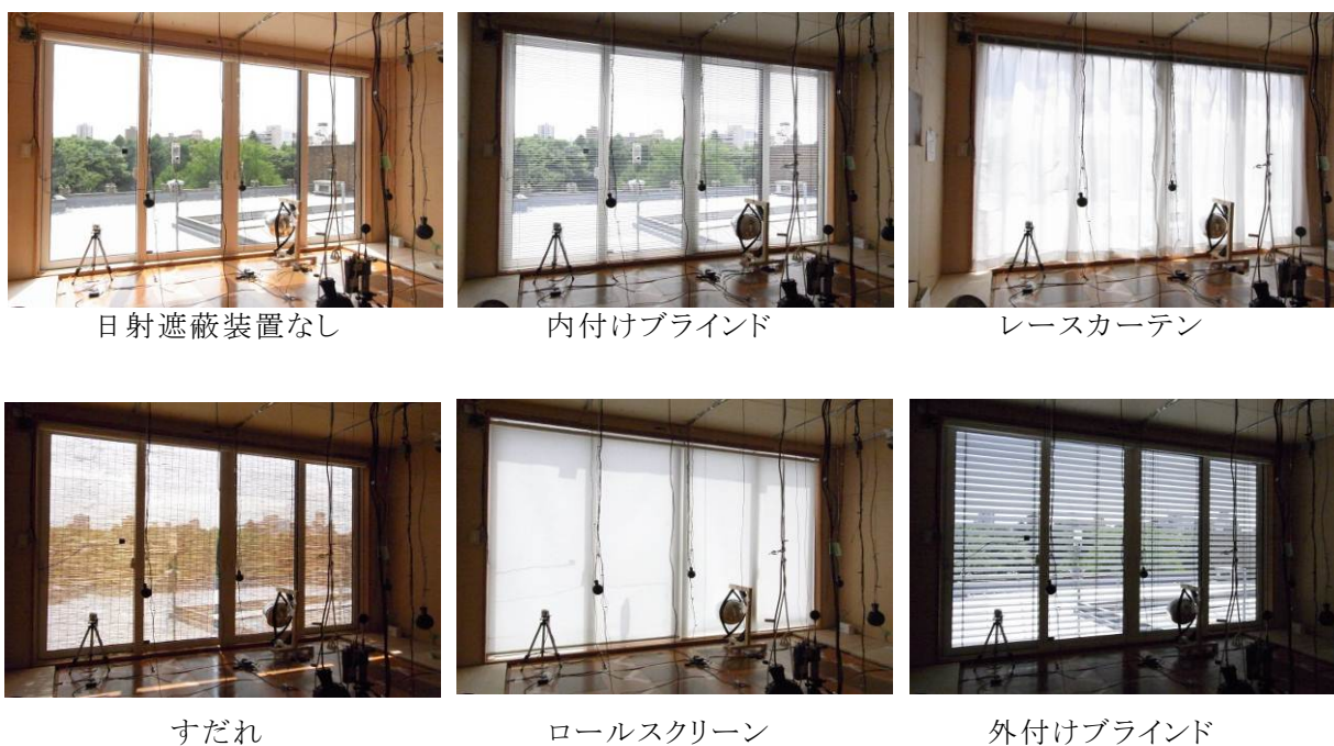
図 2.1.2 本測定に使用した日射遮蔽装置
