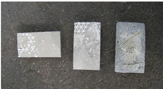
c.引張接着試験の破断面
