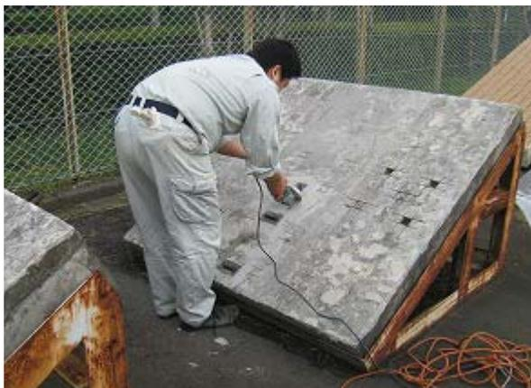
a. 引張試験機用治具の取付け
