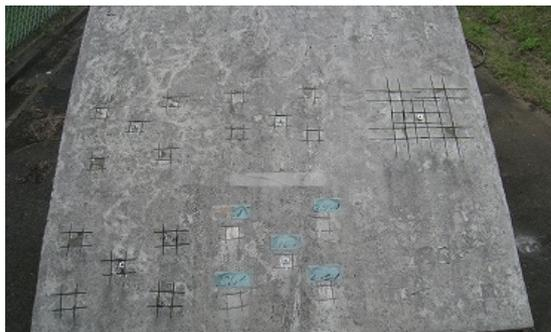
a. 地面から 45 度の傾斜で暴露した試験体の表面。汚れがひどく表面観察しにくい状態であった。
