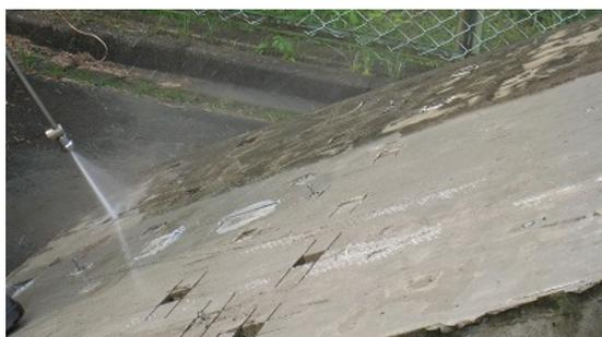
b. 表面観察を行うため暴露試験体表面を高圧水洗浄で洗浄した。
