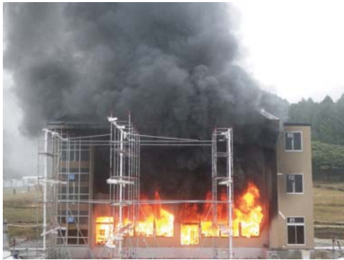
写真7 2階教室に延焼 (83分後)
