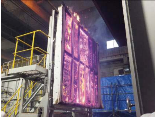
写真1 加熱試験直後のCLTパネル
