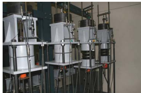
写真1 引張クリープ試験の状況
