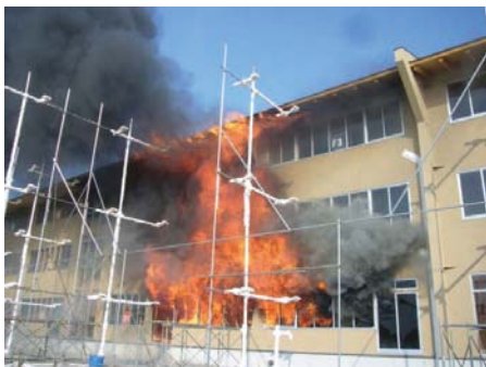
写真2 噴出火炎による上階延焼 (6分後)
