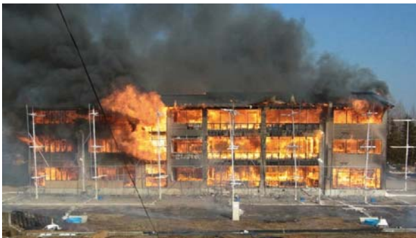
写真3 3層が同時に燃焼 (33分後)
