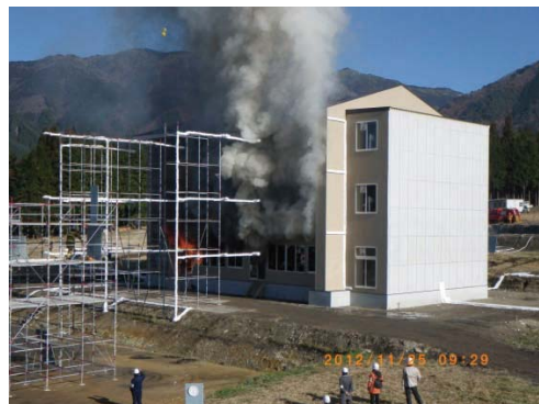
写真4 フラッシュオーバー (89分後)
