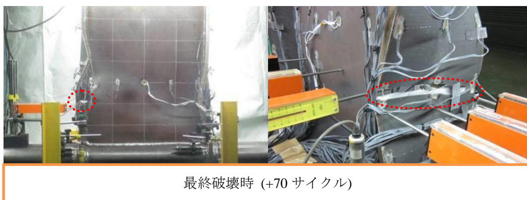
写真 2.2.2-2(c) 破壊状況(試験体 AD-3)
