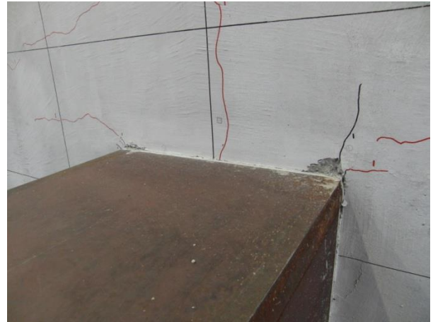
写真 2.3.2-7 最終破壊状況 (G-13-S:+17 サイクル)
