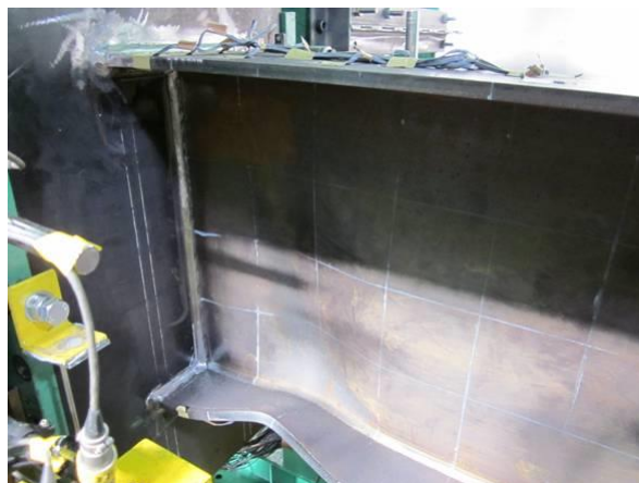
局部座屈進展(-4 サイクル目)
