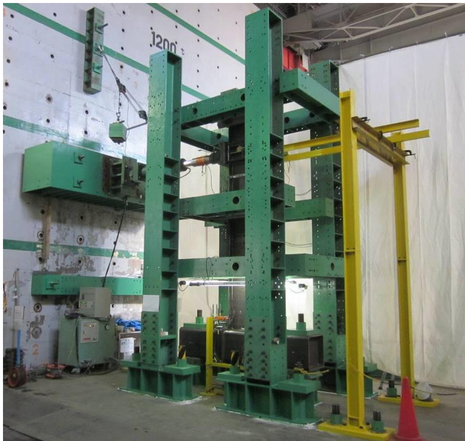
写真 2.2.2-1(a) 载荷装置全景(純鉄骨梁試験体)
