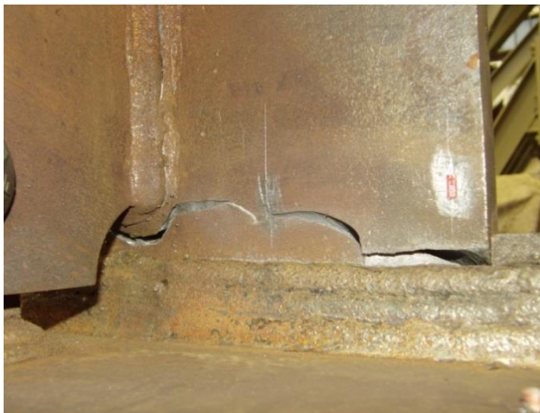
写真 2.3.2-8 最終破壊状況 (GL-13:-103 サイクル)
