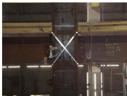
写真 3.2.5-2 梁部材角およびパネルせん断変形角測定状況
