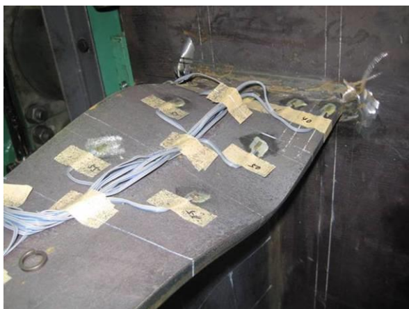
局部座屈進展(-7 サイクル目)
