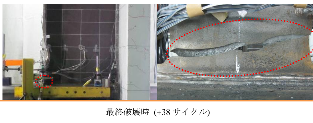
写真 2.2.2-2(f) 破壊状況(試験体 AD-2-S)
