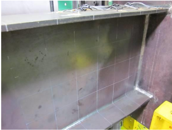
局部座屈進展(-110 サイクル目)
