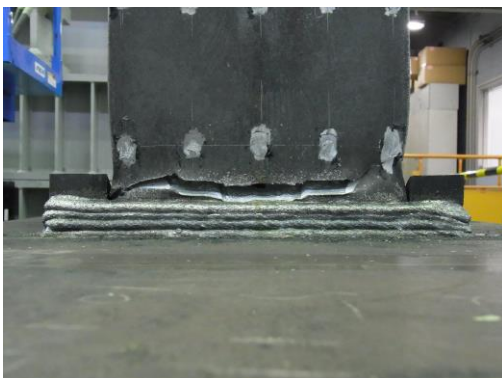
上フランジ破断状況(+7 サイクル)
