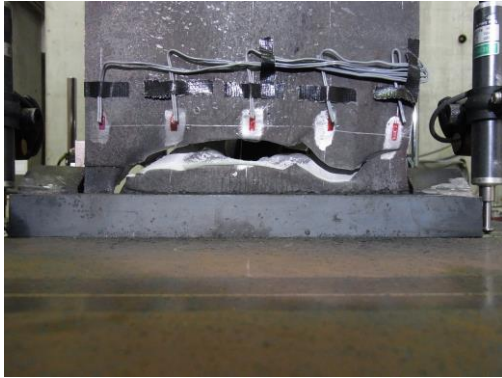
上フランジ破断状況(+5 サイクル)
