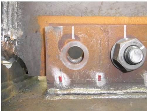
実験終了時のウェブボルト孔のずれ
