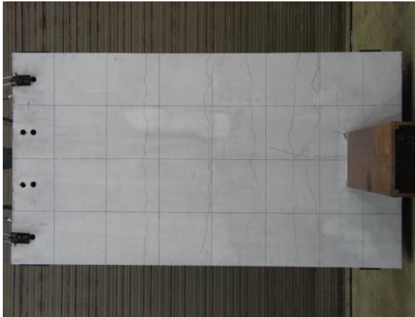
写真 2.3.2-7 最終破壊状況 (G-13-S:+17 サイクル)
