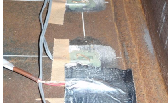
(b) ビード止端部のき裂(5 サイクル)
