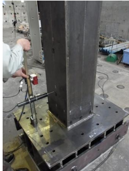
座屈高さ計測状況
