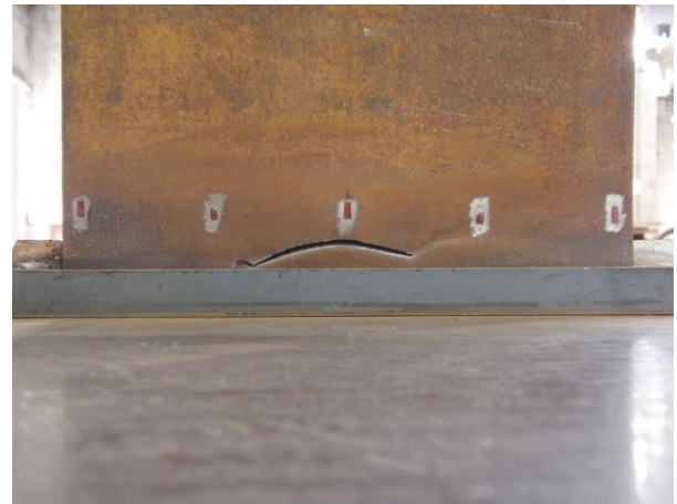
写真 2.3.2-8 最終破壊状況 (GL-13:-103 サイクル)
