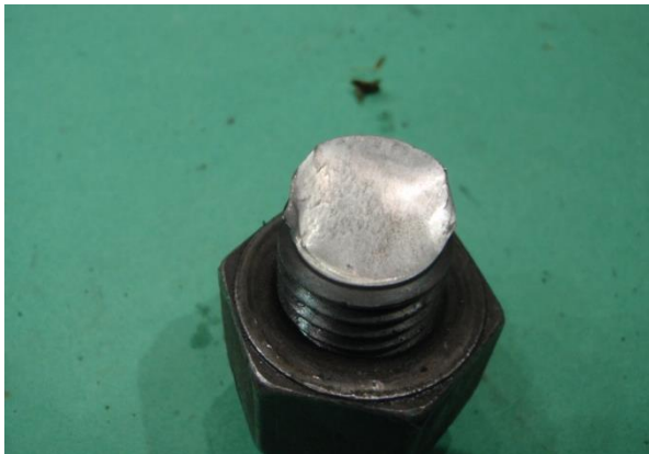
(c) 破断した高力ボルト
