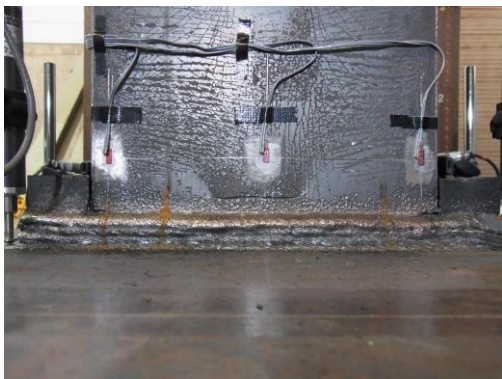
下フランジ表面の亀裂(-82 サイクル)
