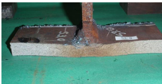
(c) 破面状況(ほとんどが脆性破面)
