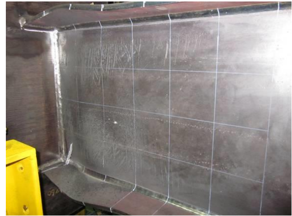
最終破壊状況(+137 サイクル目)
