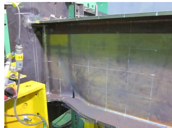
最終破壊状況(+31 サイクル目)
