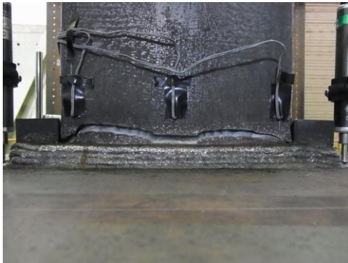
下フランジ破断状況(-20 サイクル)
