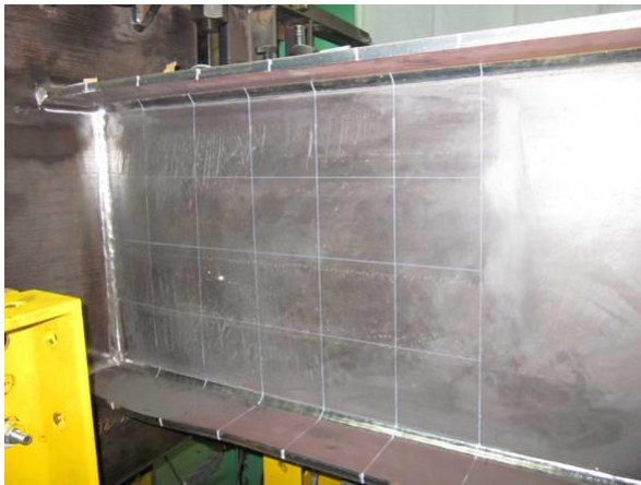
局部座屈進展(+24 サイクル目)
