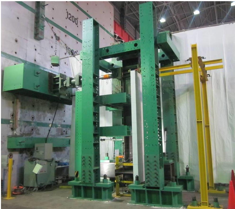
写真 2.2-2-1(b) 載荷装置全景(スラブ付試験体)
