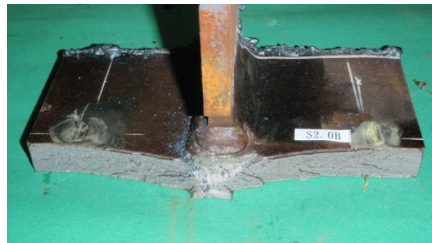
(d) 破面状況(起点部を除きほとんどが脆性破面)
