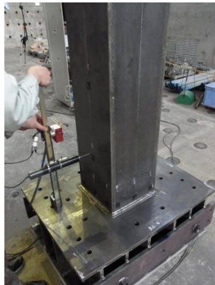
座屈高さ計測状況
