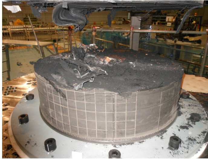
写真 2.2.1-5 破断後の試験体（下側）
