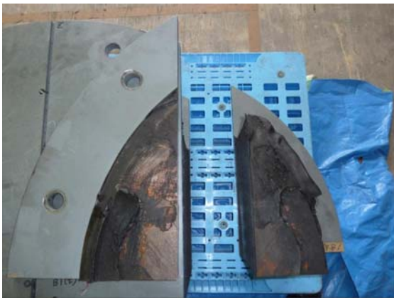
(l) 左：反転したフランジ、右：ゴム破断面 (※オレンジ色の部分は水系切削液により生じた錆)
