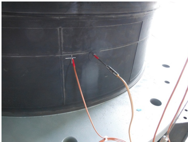
写真 2.2.1-3 被覆ゴム内部、鉛中央部の熱電対設置状況
