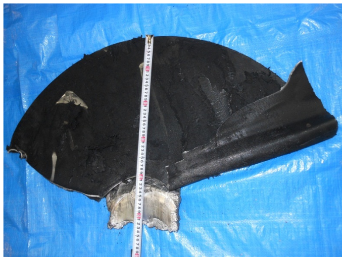
写真 2.2.1-7 飛散した鋼板と鉛プラグ
