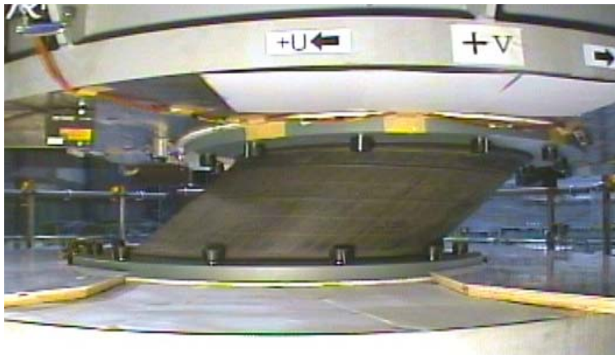
写真 2.2.1-4 400mm 変形時の試験体
