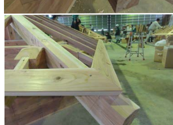
【第3回 隅木】大工技術は体系化されている隅木を通してその一端を学ぶ
