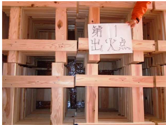
写真 2.4.3-2 実験前のクリブ設置の様子
