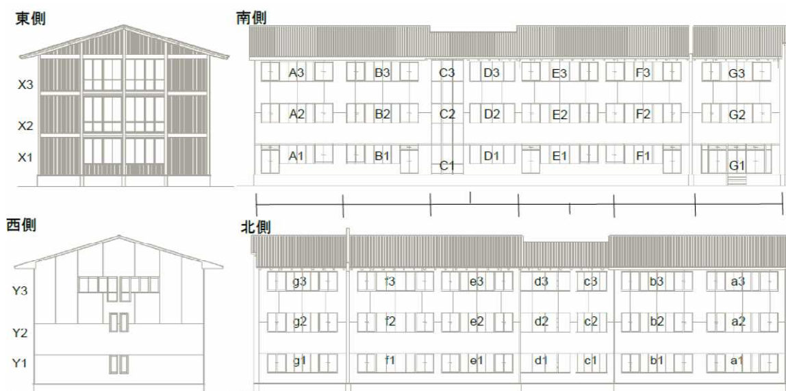
図 2.7.2-1 開口部およびスパンなどの識別記号
