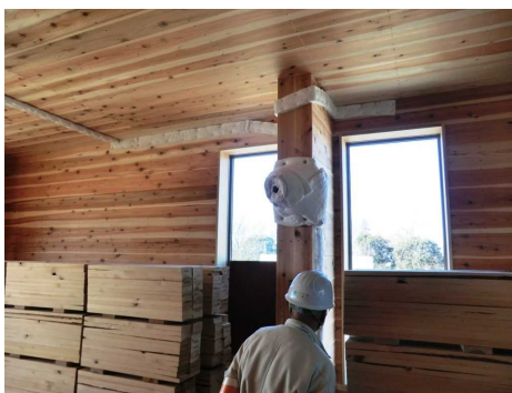
写真 2.5.2-1 建物内撮影用 CCD カメラ（耐熱加工したもの）
