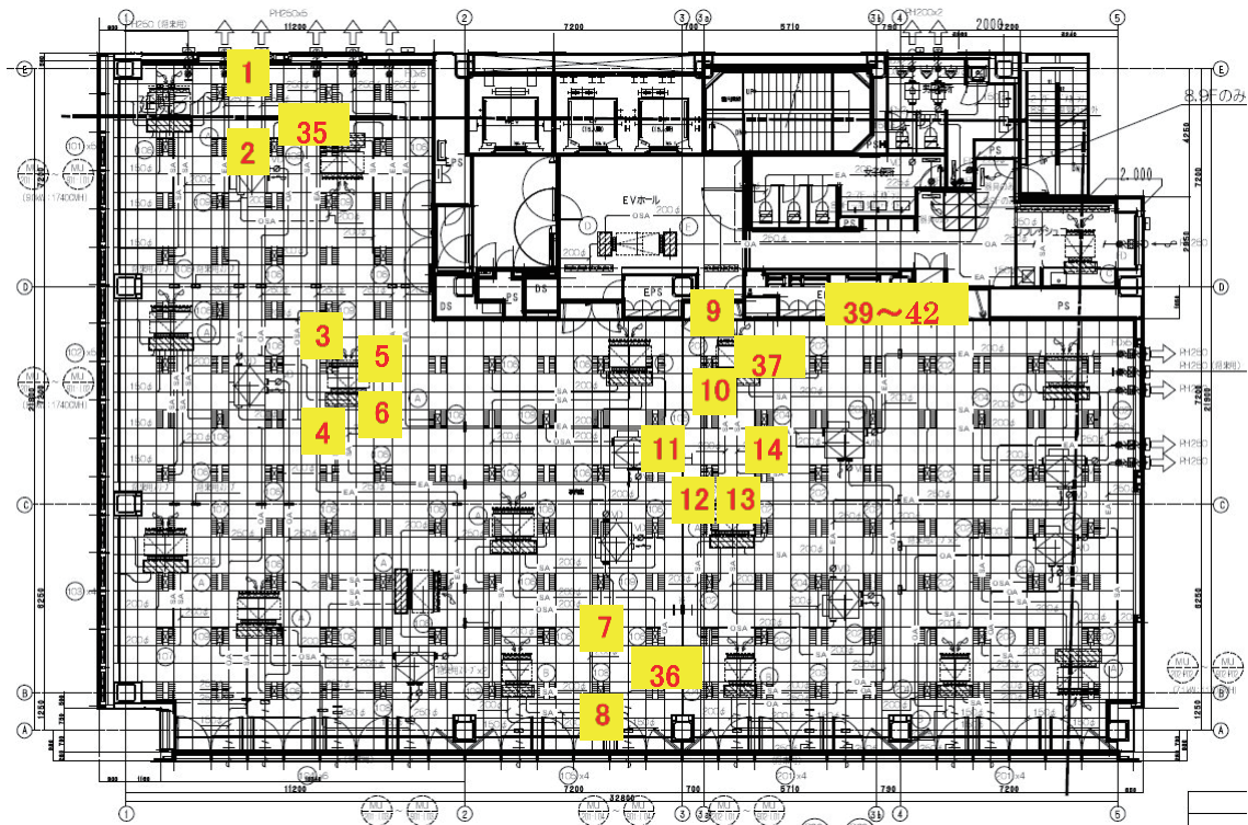
図70 センサー設置位置（天井裏）
