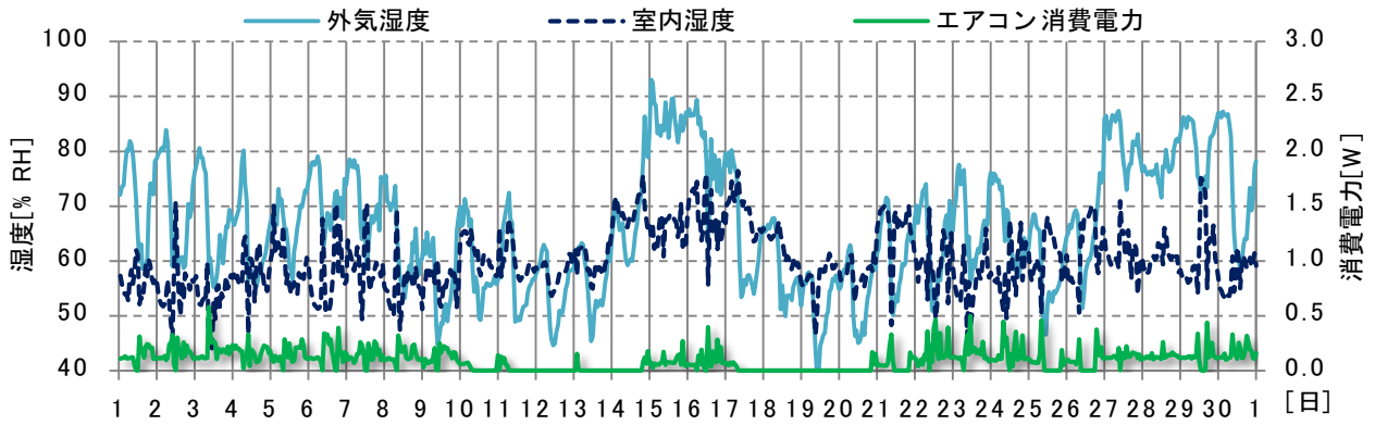
図 65 エアコン稼働状態と室内外湿度 (2015 年 9 月)
