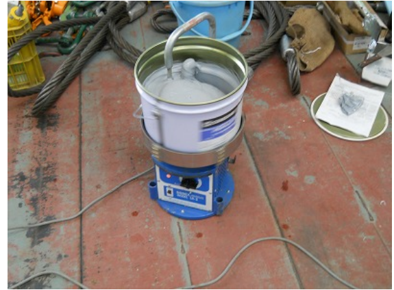
写真 3-2 防水材料 (ウレタン系継手目地材を使用)
