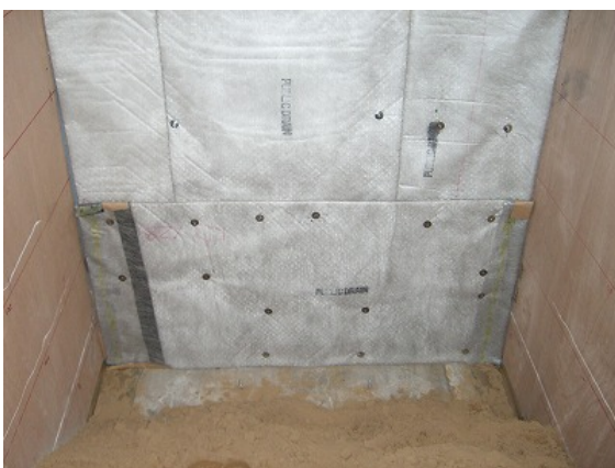
写真 7-11 試験体 No. 5 新工法 (A)+止水コンクリート
