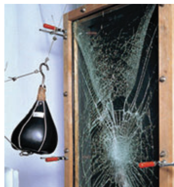
図 4-22 合わせガラスの割れ方
