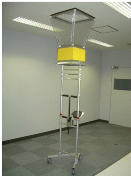
図 4-43 制気口の風量測定用機器の例
