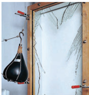
図 4-21 フロート板ガラスの割れ方
