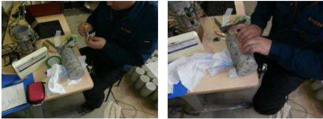
写真 9.2.10 ひずみゲージ接着
