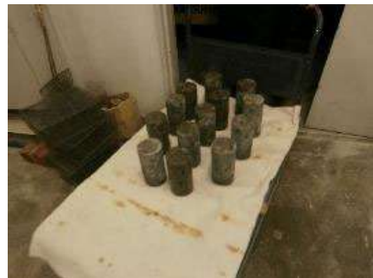
写真 9.2.9 コンクリートコア供試体の研磨
