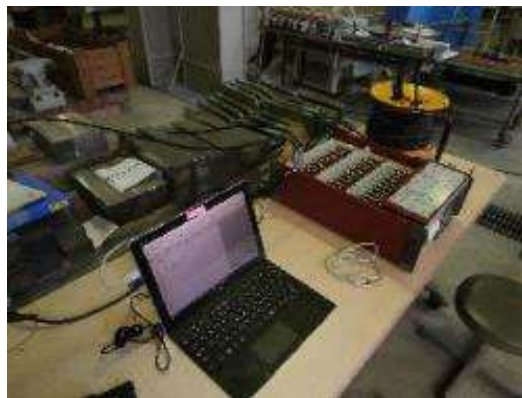
写真 9.2.11 パソコンとデータロガーの設置
