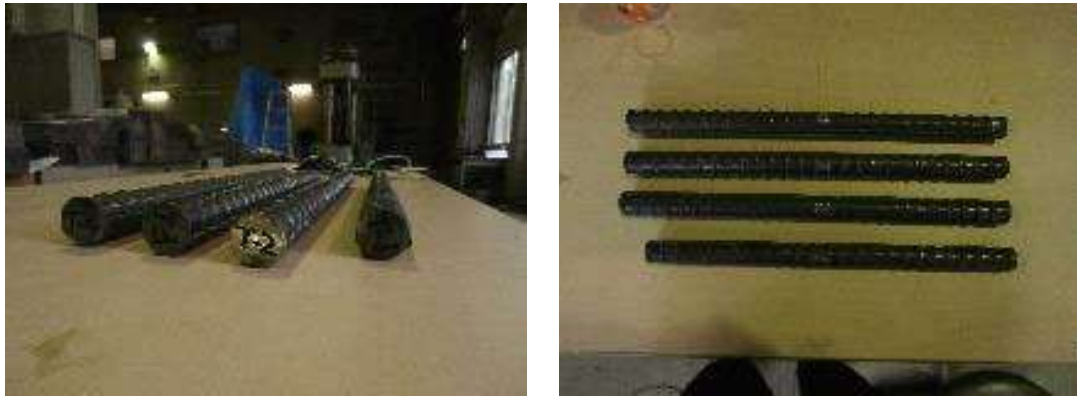
写真 9.2.14 引張り試験用鉄筋の供試体の確認
