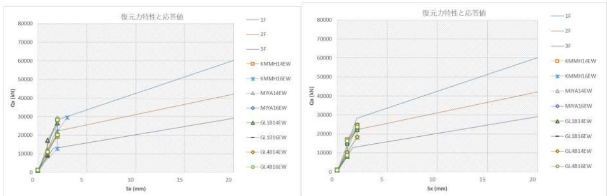
図 7.5.5.12.d X方向（EW）__SR20V05 モデルと__SR20V04 モデルの各階復元力特性と最大応答値
