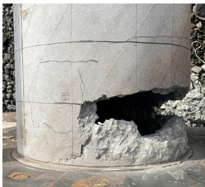
写真 3.3.9-10 コンクリート損傷箇所 (C-3, 西面)
