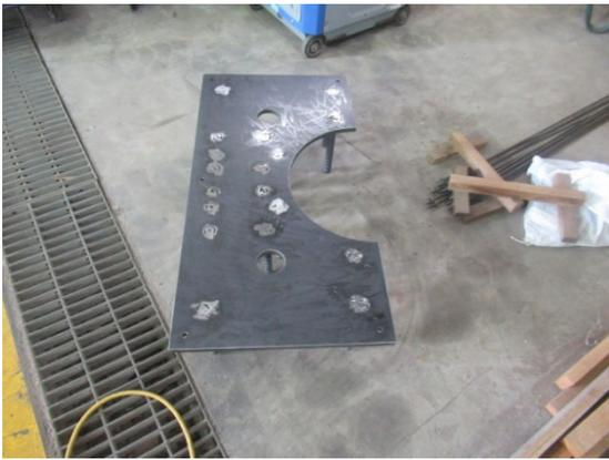
(a) 試験体スタブの補強板
