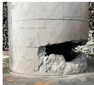
写真 3.3.10-4 鋼管除去後ハンマー軽打後 (C-3, 西面)
