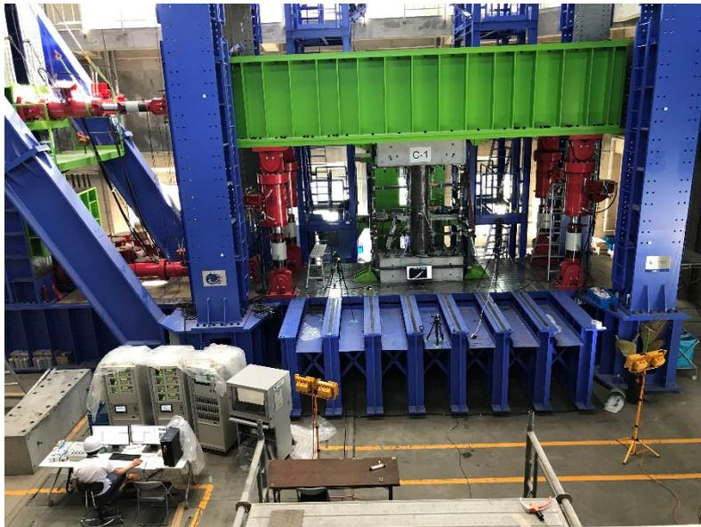
写真 3.2.4-1 載荷装置および実験実施状況
