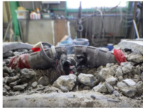
(t) R=-3.50\% 加力時 破壊状況
