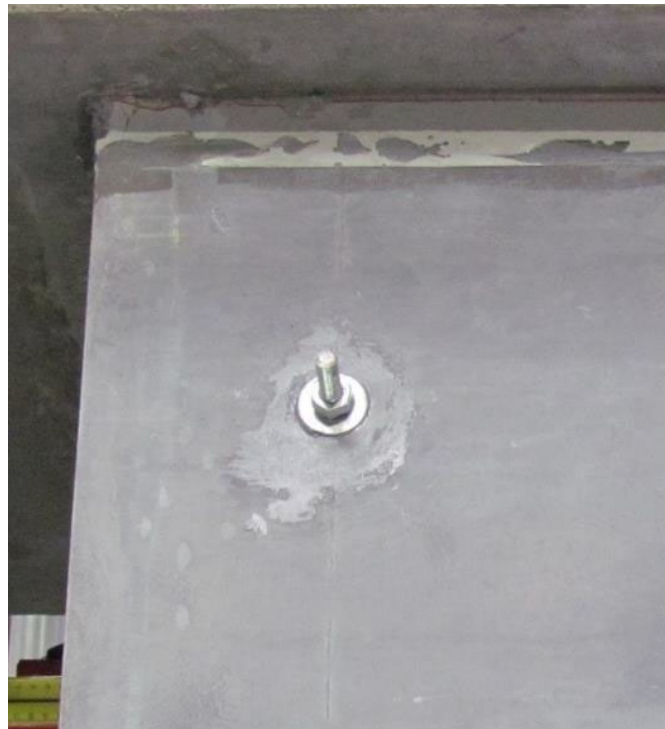
(b) 試験体正面からの写真 北上隅目地モルタルの圧壊
