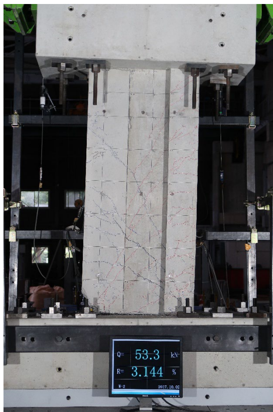
写真 5.2.4-59 R=1/33②損傷写真
