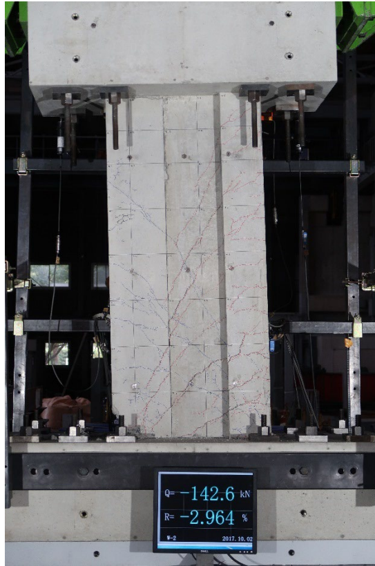
写真 5.2.4-60 R=-1/33②損傷写真
