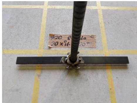
写真 4.2-3 変位計測用治具
