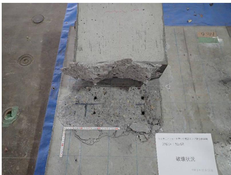
図 3.4.6-23 ひび割れ図および最終破壊状況写真 (No.6R)
