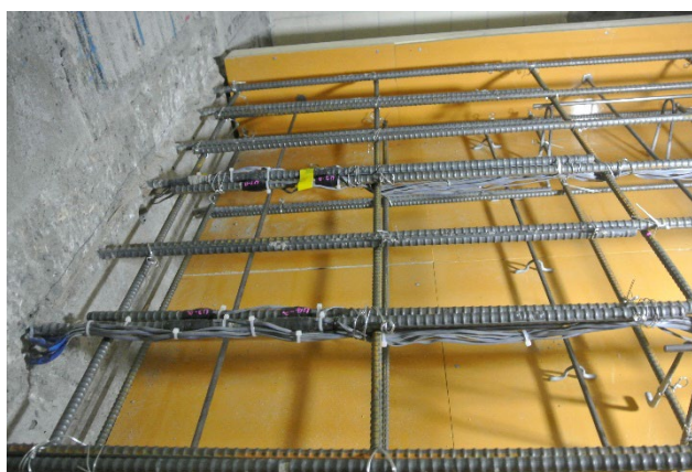
図 3.3.5-4 アンカー筋および定着筋のひずみ測定位置(平面図, 写真)
