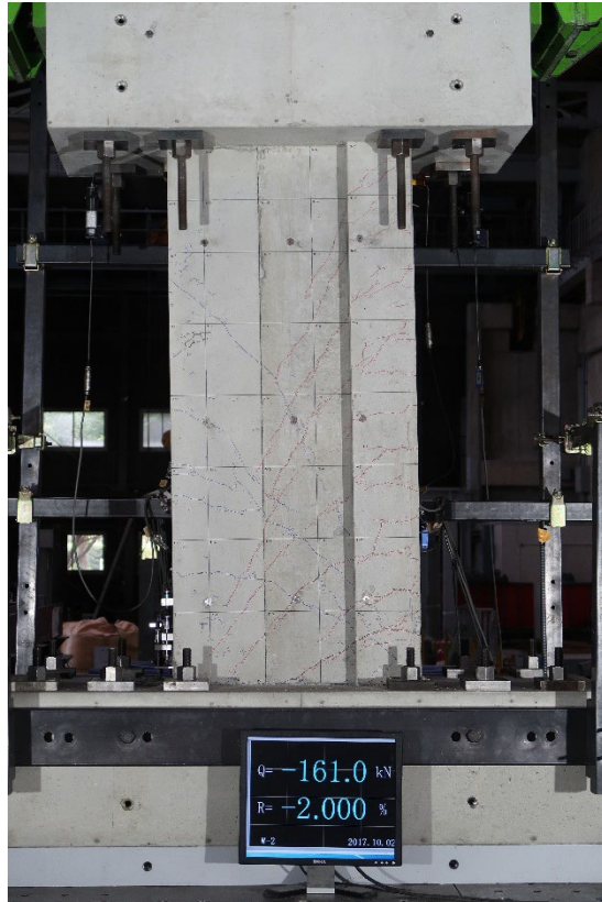
写真 5.2.4-56 R=-1/50②損傷写真
