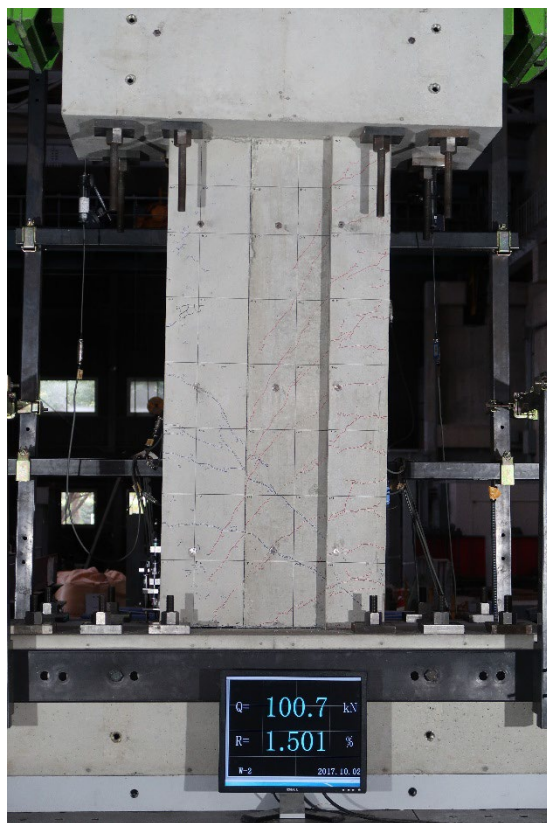
写真 5.2.4-51 R=1/67②損傷写真
