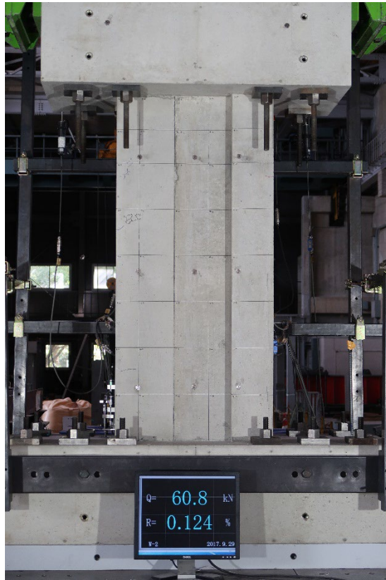
写真 5.2.4-31 R=1/800 損傷写真
