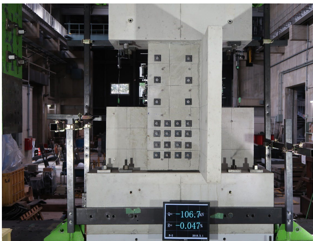
付写真 1.2.4-32 B-2 全景写真(R=-1/1600)
