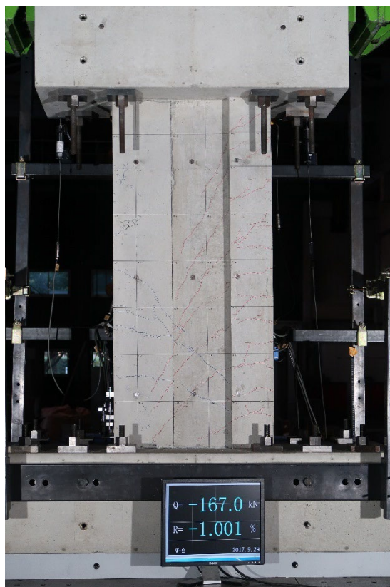
写真 5.2.4-48 R=-1/100②損傷写真
