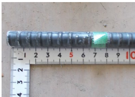
写真 3.3.6-7 高強度鉄筋 (MK785) 写真 3.3.6-8 埋込長さ (5da=65mm)
