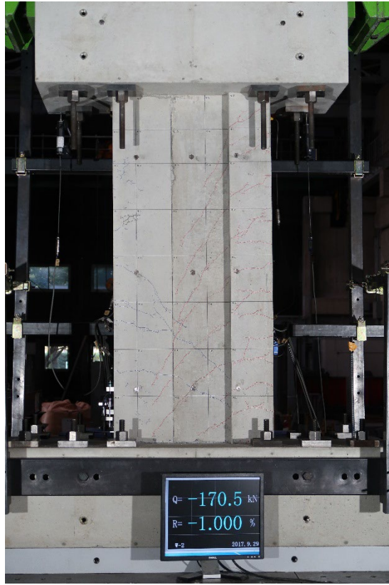
写真 5.2.4-46 R=-1/100 損傷写真
