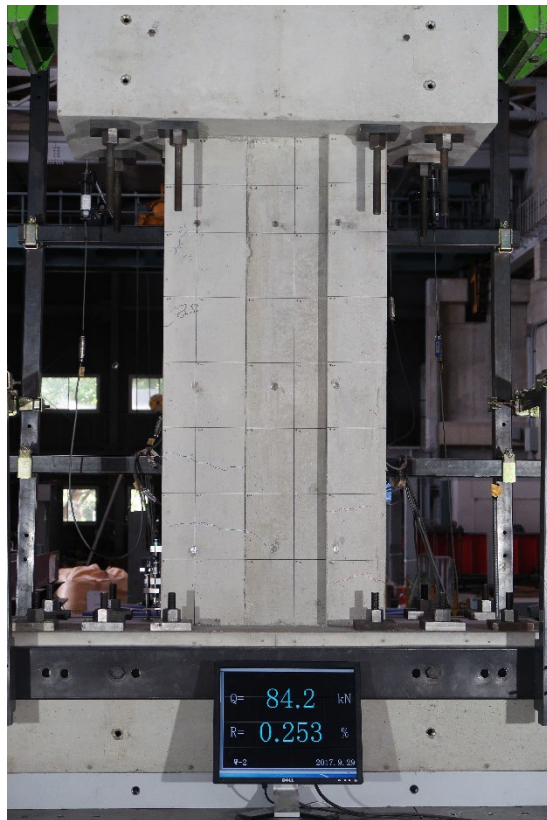
写真 5.2.4-33 R=1/400 損傷写真
