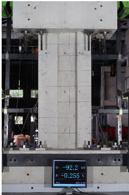
写真 5.2.4-36 R=-1/400②損傷写真
