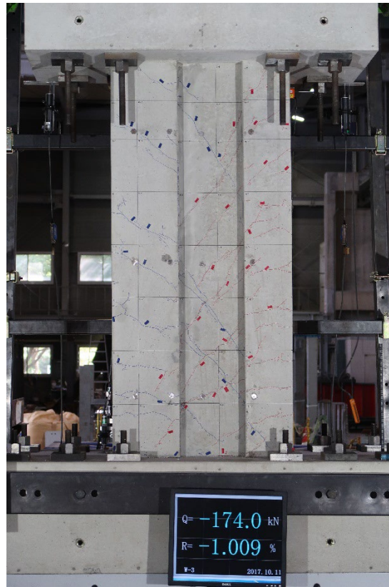
写真 5.2.4-80 R=-1/100②損傷写真
