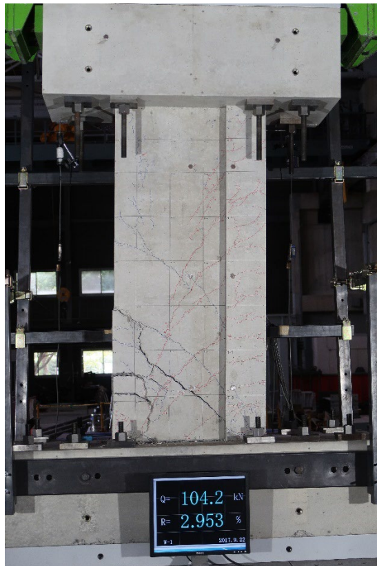
写真 5.2.4-28 R=1/33 損傷写真
