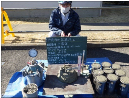
写真 8.2.2-27 コンクリート受入検査
