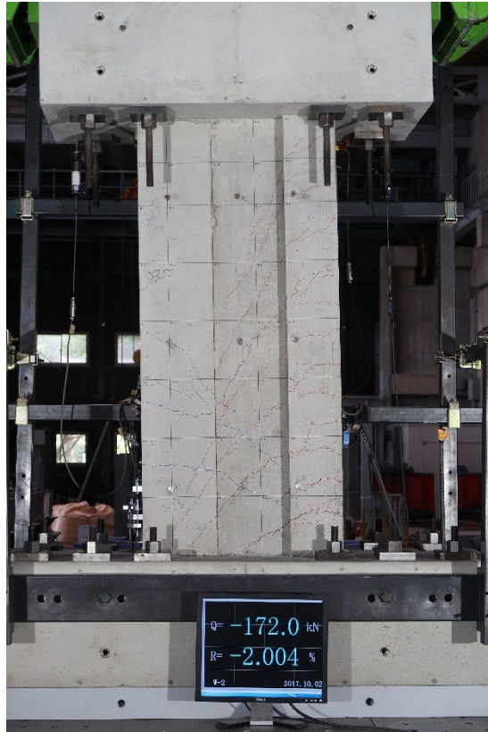
写真 5.2.4-54 R=-1/50 損傷写真
