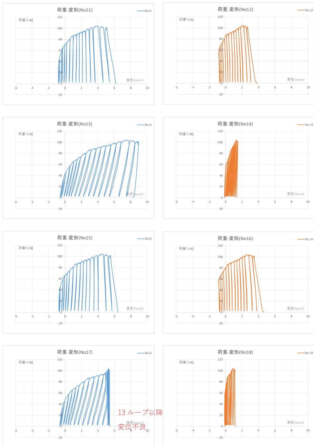
201号室 階段側壁の変形 201号室 妻側壁の変形 図 3.3.7-18 201号室 既存壁（階段室側，妻側）の荷重—変形曲線 （測定点 No.11～No.18）
