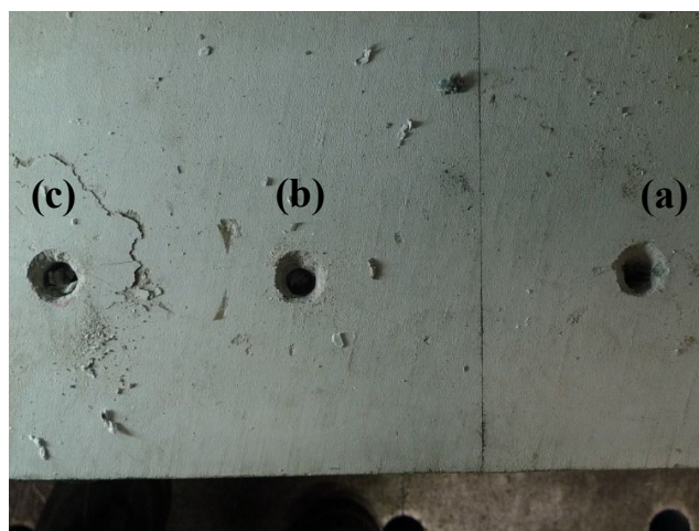
写真 5.3.5-2 穿孔した孔 a/b/c の引き抜き試験後の状況
