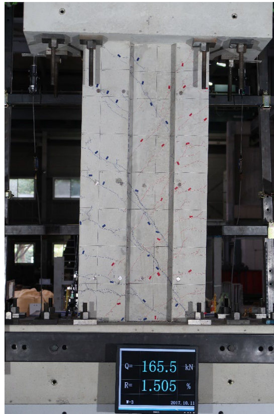
写真 5.2.4-83 R=1/67②損傷写真
