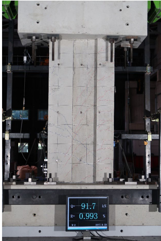
写真 5.2.4-45 R=1/100 損傷写真
