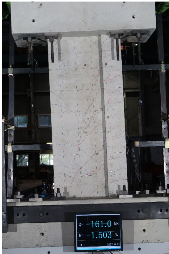
写真 5.2.4-22 R=-1/67 損傷写真
