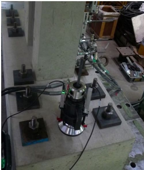
図 5.2.5-4 スタブに埋め込まれた アンカー筋
