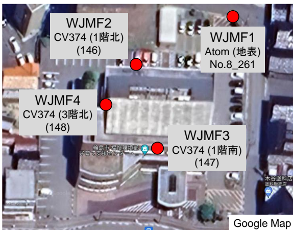
図 4. 4-5 WJMF 強震計・地震計設置位置
