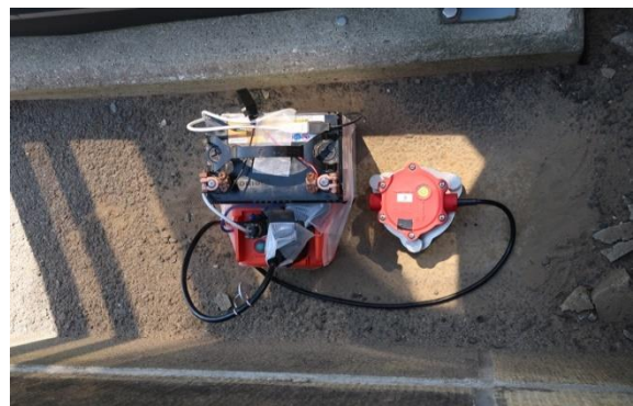
写真4.4-2 地震計設置状況 (WJMS1：北東側地表、Atom No.9_262)
