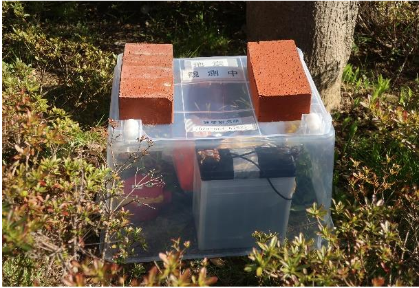
写真 4.4-12 地震計設置状況 (WJMF1 : 北側地表、Atom No.8_261)
