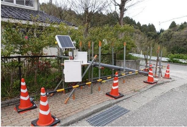
写真 5. 3. 2-188 地盤変位のモニタリング
