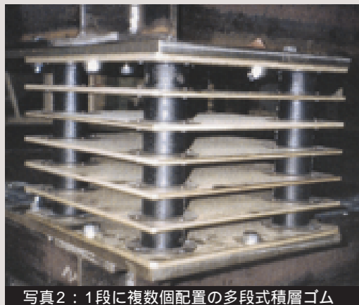
写真2：1段に複数個配置の多段式積層ゴム
