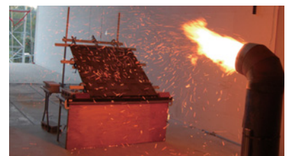
■写真5 火の粉による飛び火の解明に向けた取り組み
