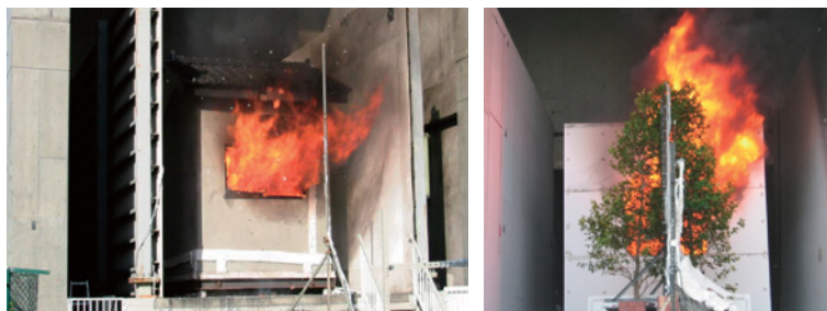
■写真3 実際の家屋を用いた火災実験の様子 室内の火災がある時期に一気に拡大し（フラッシュオーバー）、室全体に及ぶと、火災は窓から噴出します。
