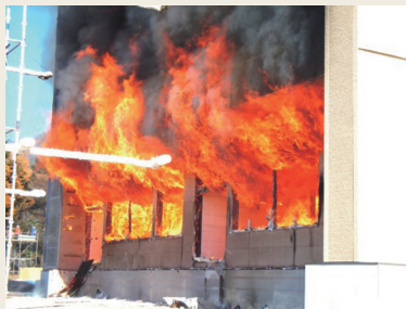
写真2 バルコニーによって火炎が 上階に届きにくくなっている状況
