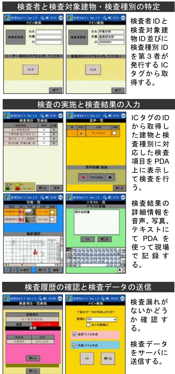
図 3 検査支援システムの概要と操作画面
