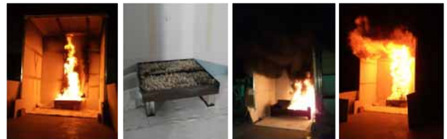
図 5 異なる火源による比較実験
