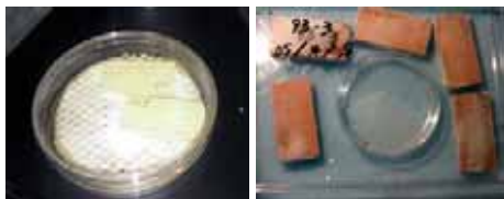
写真3 木材腐朽菌の接種 (オオウズラタケ)
