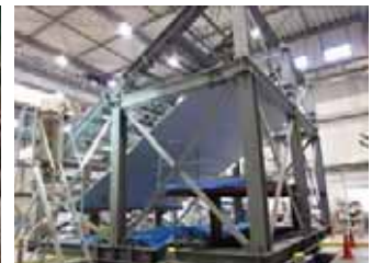
写真 2 天井振動台実験
