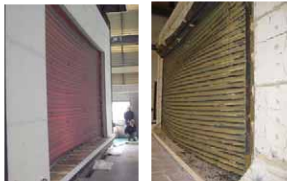
図 7 加熱中（非加熱側）及び加熱後（加熱側）の状況
