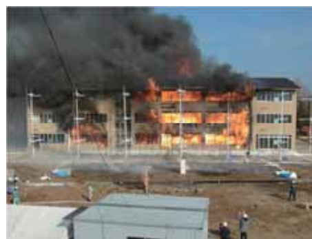
図5 木造3階建て学校の実大火災実験
