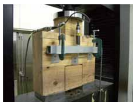
図3 CLT の面内せん断試験の様子
