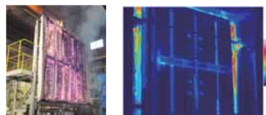
a) 小型試験体 b) 目地部の熱画像
