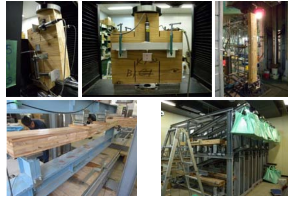
図2 CLT の材料性能の評価試験の様子 (解説) 左上：ツールールシヤによるせん断試験、中央上：LW 改良法によるせん断試験、右上：座屈試験、左下：曲げ試験、右下：長期荷重載荷試験
