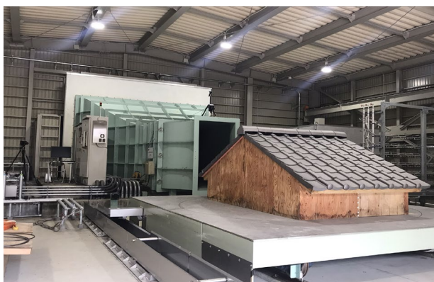
実大強風雨発生装置での瓦屋根の飛散実験
