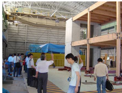
木質構造と鉄筋コンクリート造を組合わせた複合建築構造の振動台実験（平成 15 年 8 月 30 日）
