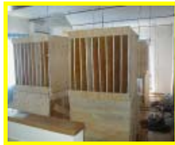
ホルムアルデヒド放散源を一定量設置、異なる温度及び換気量条件で濃度を計測した
