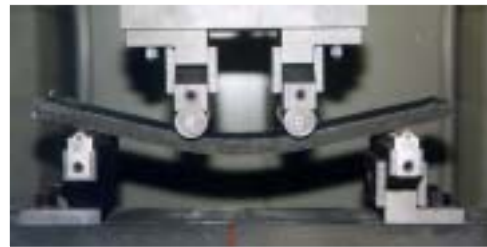
高靱性コンクリート板の曲げ試験
