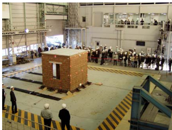
平成19年12月に実施した、パキスタン製レンガの実大構造物の振動台実験
