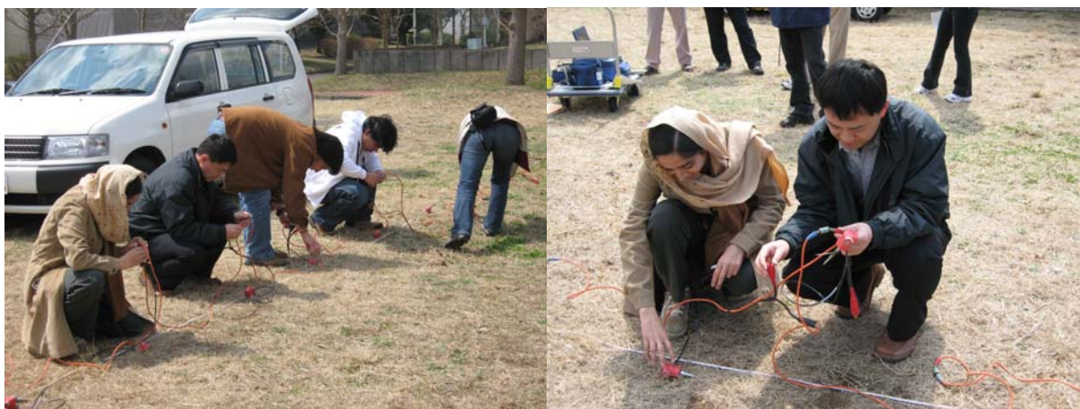
地盤の常時微動測定の様子
