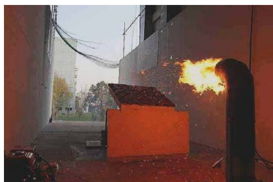
火の粉シャワーに曝された屋根の延焼可能性を調べる火災風洞実験の様子
