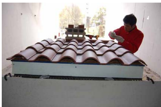
火の粉シャワーに曝された屋根の延焼可能性を調べる火災風洞実験の様子
