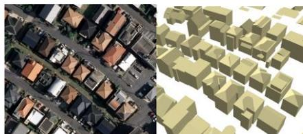
図1 現況航空写真(左)と作成したシミュレーション用3次元モデル例(右)
