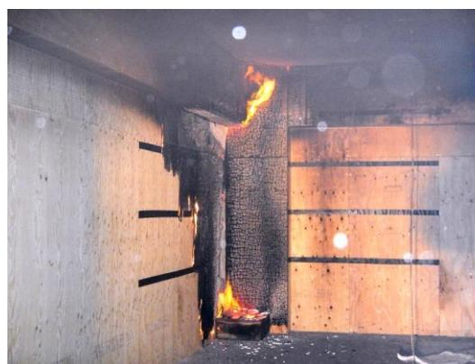
図3 天井を不燃化した火災実験における木質内装の燃え止まり(既往実験)
