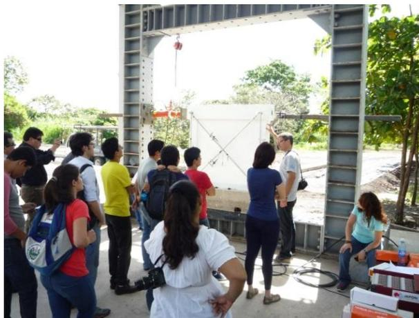
写真一1. 5. 1. 1 コンクリートブロックを用いた枠組組積造壁試験体の加力準備(UES 実験棟)
