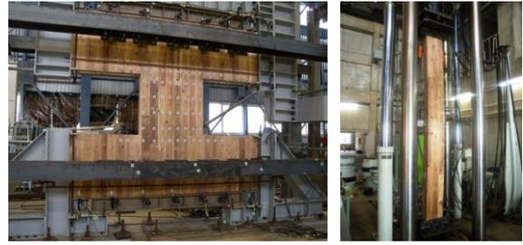
図2 CLT の材料性能の評価試験の様子
