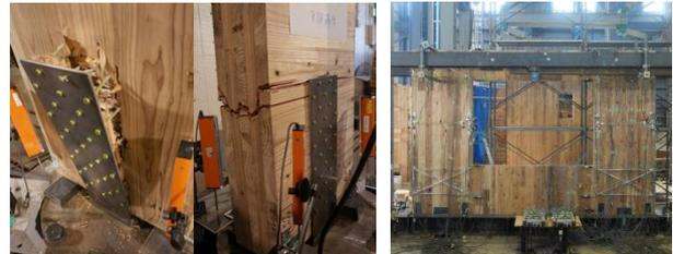
図2 接合部の試験(左)と構面の試験(右)の様子
