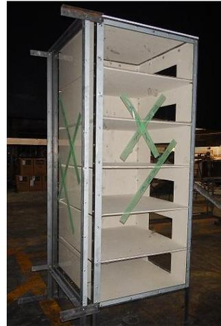
図5 煙流動実験に用いたダブルスキン建築の模型
