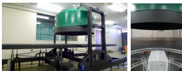
写真1 竜巻発生装置の外観と模型の設置状況
