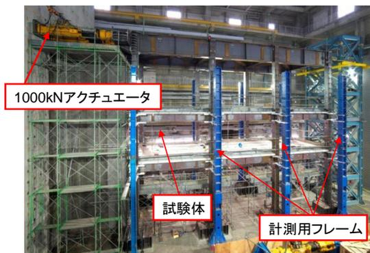
図 5 鉄骨造実大 3 層骨組の載荷実験
