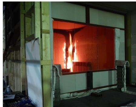
図6 開口の大きさや天井高さ等によるフラッシュオーバーの遅延効果を確認する火災実験
