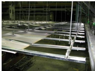
写真5 耐風圧クリップ使用でのボード落下
