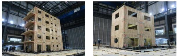
図3 実大加振試験の様子
