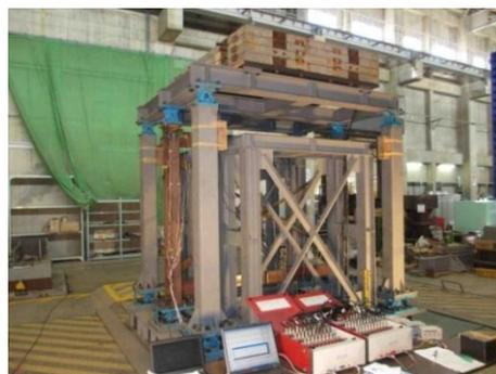
図3 引張ブレース骨組の振動台実験
