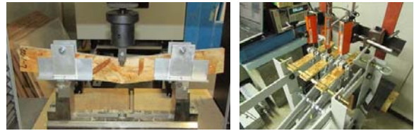
図1 OSB の短スパンせん断試験(左)とクリープ破壊試験(右)
