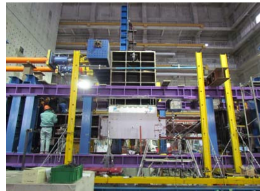
写真 1 パイルキャップを有する実大部分架構実験
