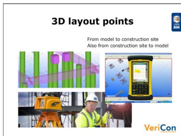
図5 モデルと実現場の座標管理手法の例 (出典：5 th SG Gov. BIM Sympo.資料)
