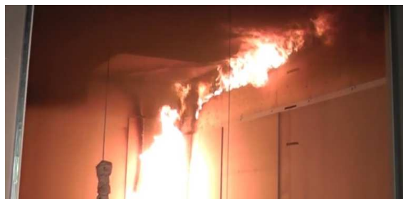
図 4 煙層の予熱による火災伝播の実大実験
