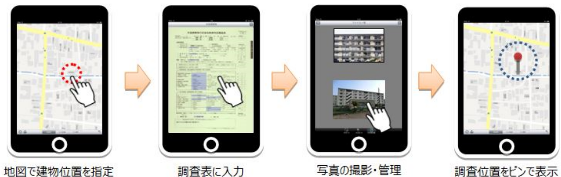
図-I-1. 2. 14 応急危険度判定支援ツールの入力・表示のイメージ
