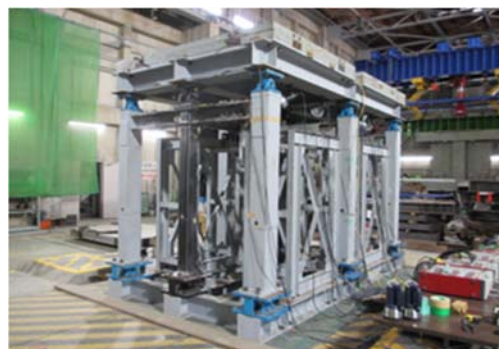
写真 2 2スパン骨組の振動台実験
