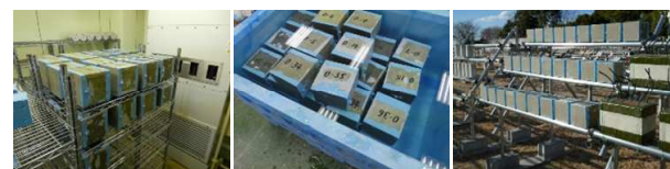
中性化促進状況 塩水浸漬状況 屋外暴露状況 写真1 試験状況
