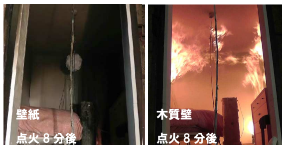
図 5 家具等を配置した室の内装燃焼実験
