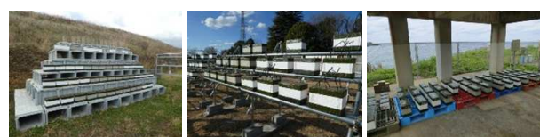
北海道(泊) つくば-雨掛かりあり 沖縄(辺野喜) 写真2 屋外暴露状況
