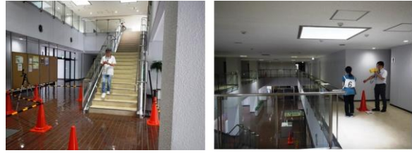
図4 スマホによる避難誘導の活用可能性を評価するための歩行速度の実測
