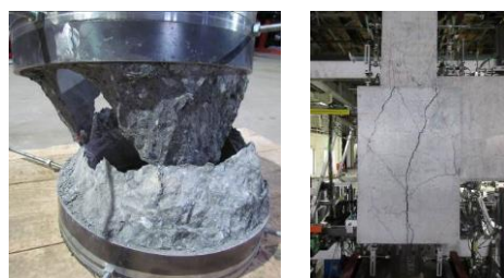
図2 杭頭部および部分架構の構造実験
