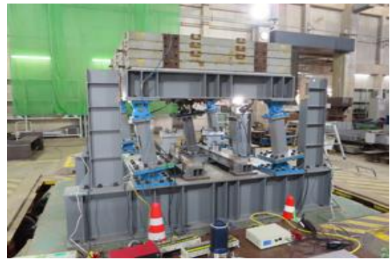
写真3 角形鋼管柱の振動台実験
