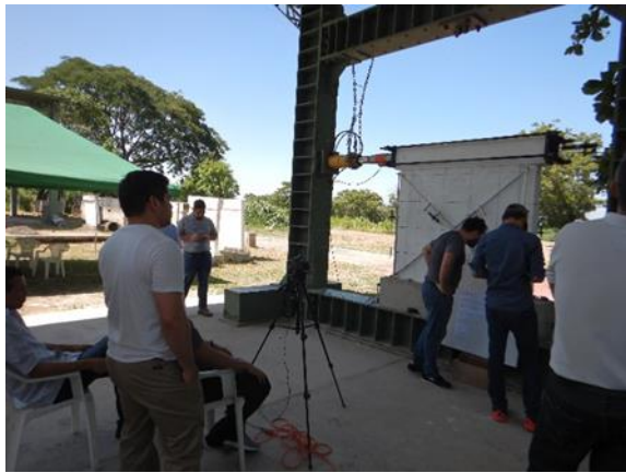
写真-I-2. 1. 7 枠組組積造壁の水平載荷実験の様子 （国立エルサルバドル大学）
