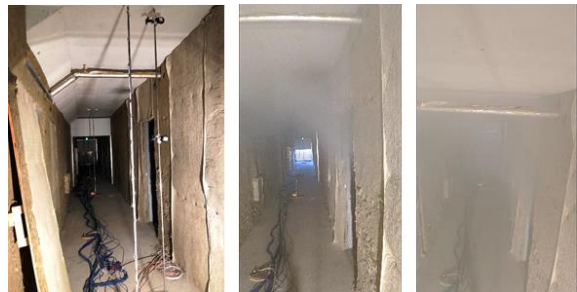
図6 居室・廊下の温度センサ・防犯カメラによる火災状況の即時把握の検証実験
