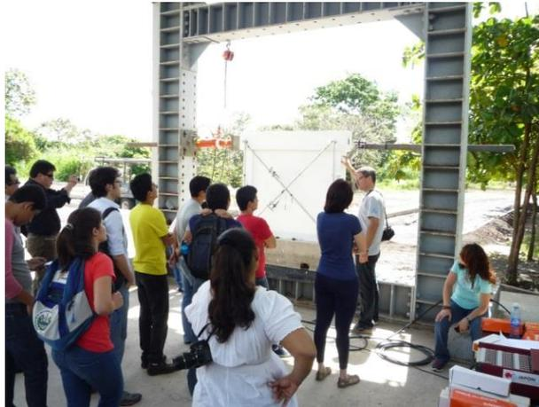
写真一2 コンクリートブロックを用いた枠組組積造壁試験体の加力準備(UES 実験棟)
