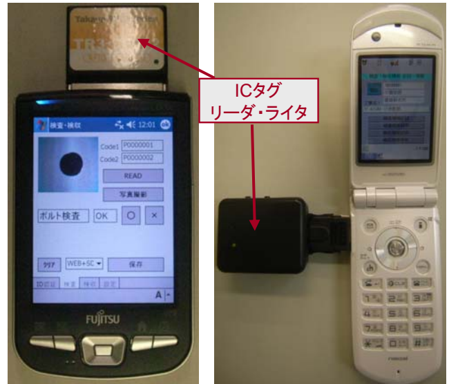
図18 実験で使用したICタグを読む機能を付けたPDA（左）と携帯電話（右）
