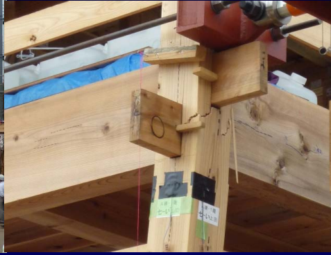
静的加力実験による 通し柱の折損
