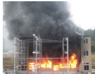
2階から噴出火炎 83分後
