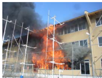
噴出火炎による上階延焼(6分後)
