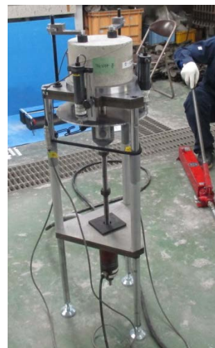
引抜き試験状況
