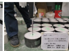
樹脂注入状況
