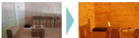
火源: 木材クリの燃焼や落下に伴うFO時間のバラツキを防ぐため、ガス量を制御(100kWで10分間、以後300kW)したLPGバーナーを使用。
