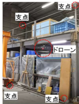
写真2 ドローンによる(微)破壊試験用係留方式の開発
