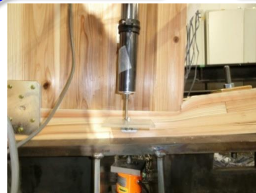
土台のめり込み
